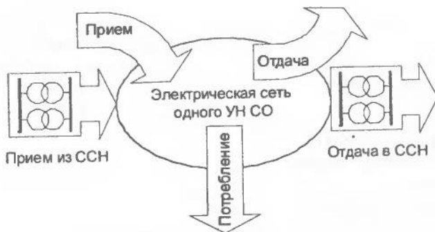
Рис. 1.2. Баланс электрической энергии для одного уровня напряжения
