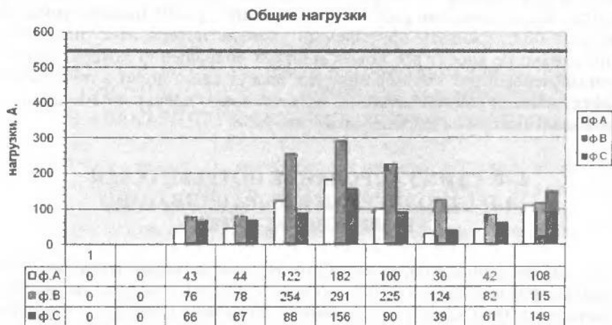
Рис. 2.2. Диаграмма измеренных токов фаз ( A , B и C ) по датам замеров
