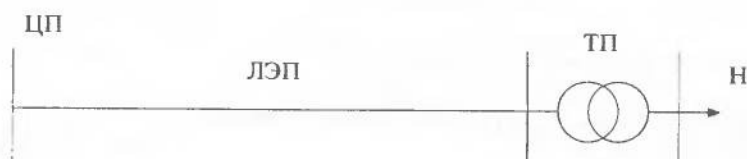
Рис. 2.3. Схема питающей электрической сети 10 кВ
